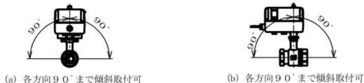
図2 取付姿勢（図はネジ込み形）
